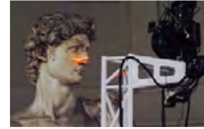
Şekil 6. Bir heykelin laser ile taranması [12]
